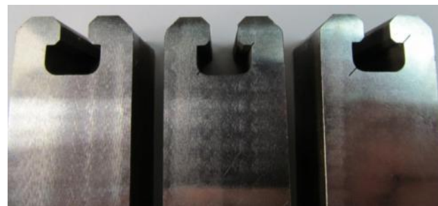
Próbki odniesienia dla stopnia A1: Od lewej: bez wad, nacięcie 1mm, nacięcie 2mm
