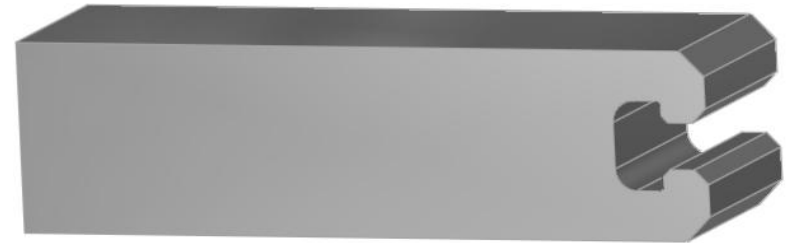
Widok 3D modelu wycinka wrębu wirnika turbiny parowej:
