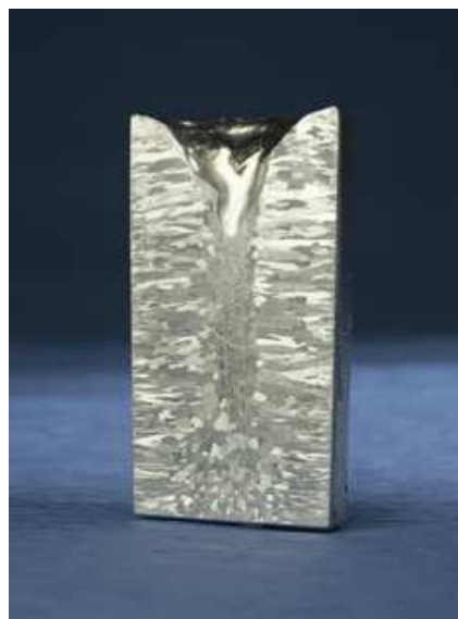
Rysunek 12.12. Mikrostruktura wlewka. Ziarna zamrożone – 1, ziarna słupkowe – 2, ziarna wolne – 3, jama usadowa – 4
