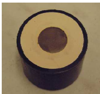
Rysunek 11.3. Zgląd metalograficzny z zainkludowaną próbką
